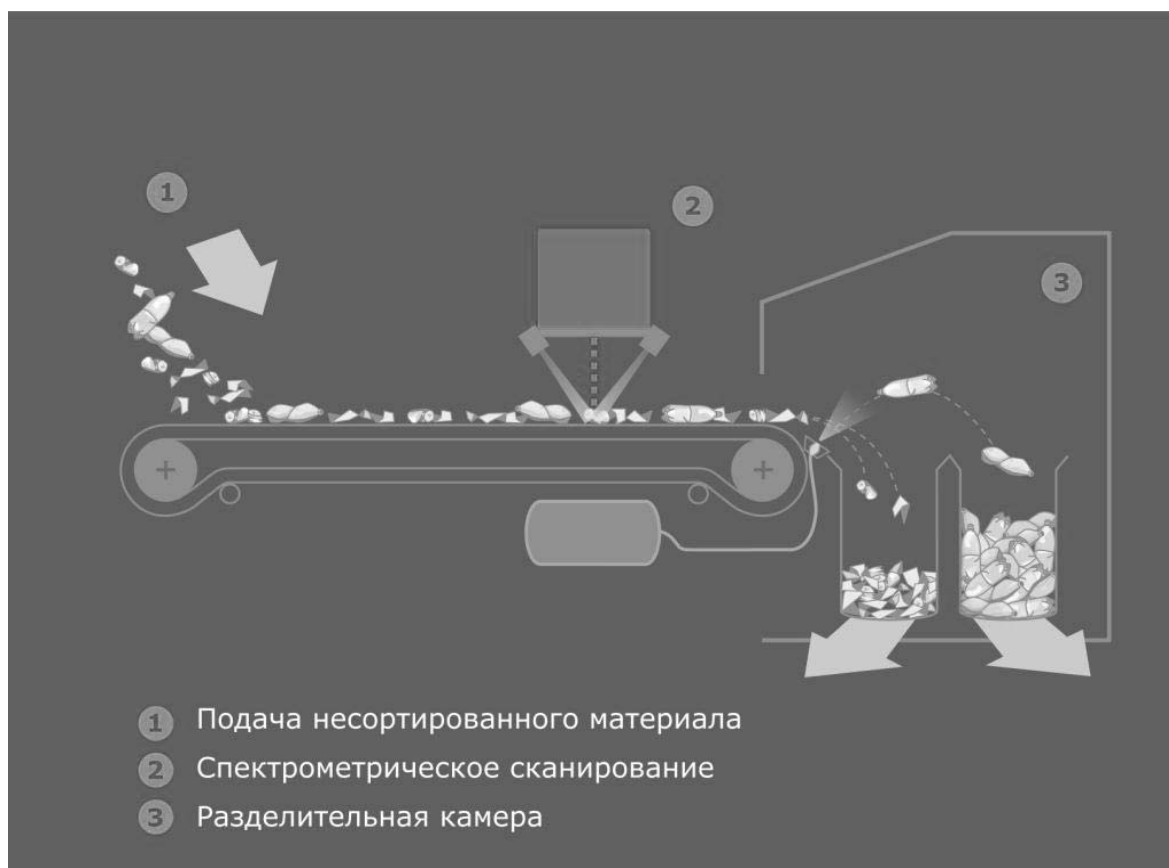
Рисунок 5 – Схема работы оптического сепаратора
